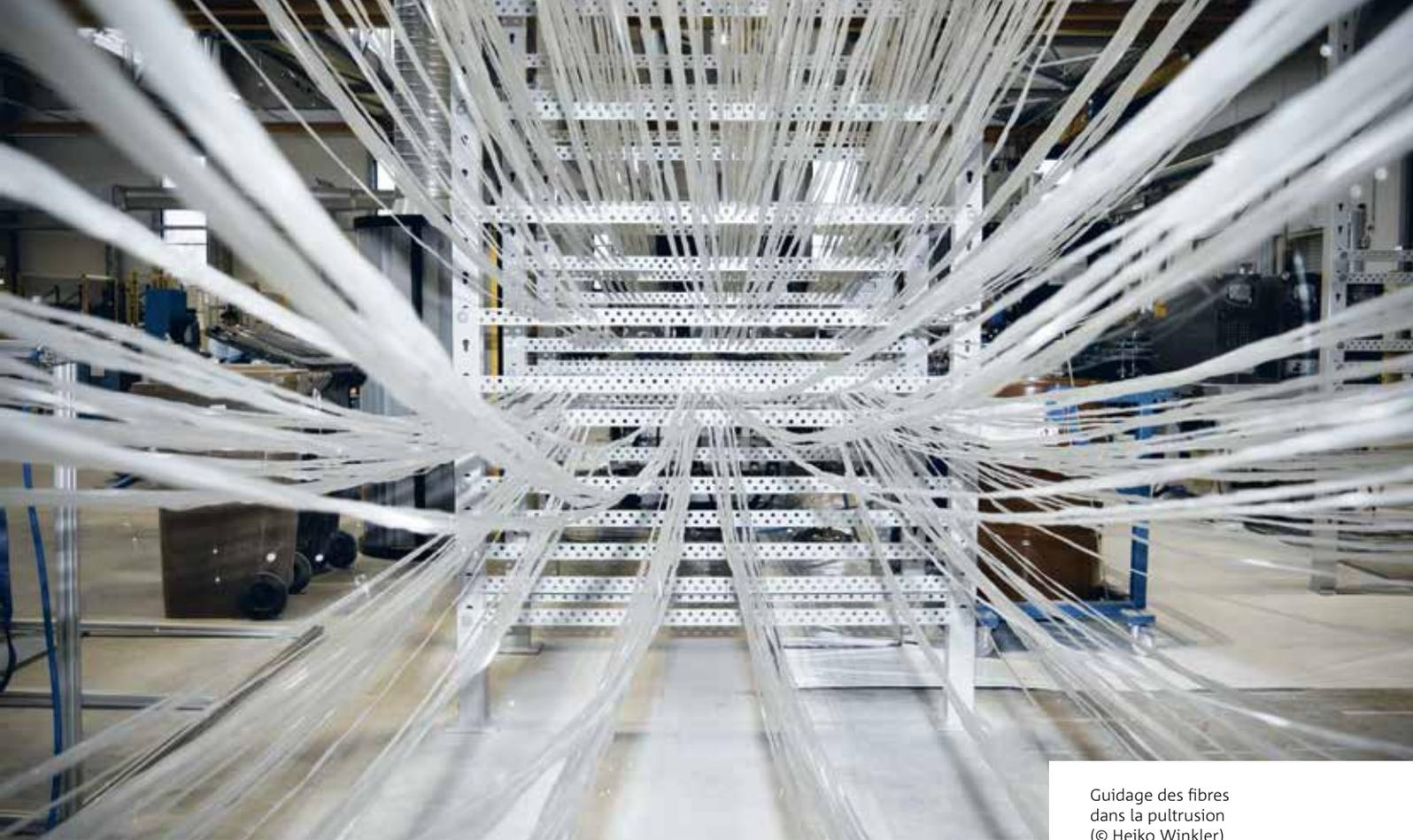
Guidage des fibres dans la pultrusion
