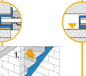
Nach dem Einbau des Wandelements Tronsole® Typ Q Part W ist die Höhenlage der Treppe durch druckfeste Ausgleichplatten (z. B. aus Stahl, Mindestgröße 160 x 110 mm) zu justieren.
