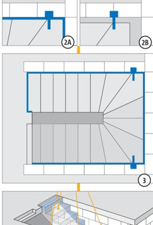
**WARNING** Gefahr durch abstürzendes Bauteil bei unvollständigem Einbau! Es müssen alle Parts Tronsole® Typ Q (Parts W + T) verbaut werden.
