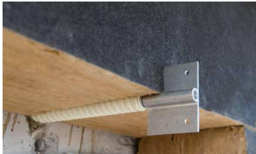
Der Fassadenanker Schöck Isolink® Typ TA-S besteht aus Glasfaserverbundwerkstoff in Verbindung mit einer Edelstahlschraube. Bei Schöck Isolink® übernimmt ein Combar® Glasfaserstab mit äußerst geringer Wärmeleitfähigkeit die Funktion der thermischen Trennung und erfüllt damit zuverlässig die Anforderungen an den Wärmeschutz. Als „Zertifizierte Passivhaus-Komponente“ ermöglicht Schöck Isolink® eine rechnerisch wärmebrückenfreie Konstruktion.
