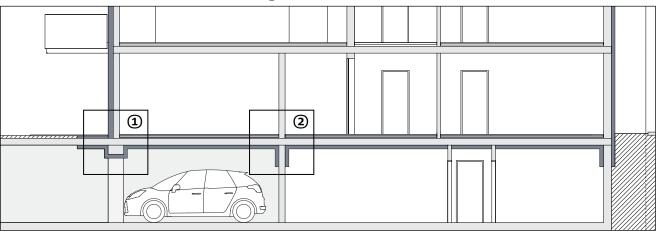
Unterdeckendämmung mit Holzwolle-Mehrschichtplatten
