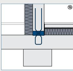
Variante B: Unterzug und Decke in Sichtbeton
