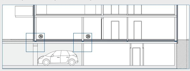
Variante B: optimiert mit Sconnex, Aufdeckendämmung und Sichtbetondecke. Dämmung vollständig auf der Decke verlegt.
