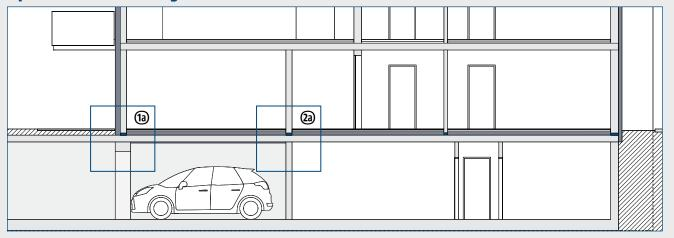
Variante A: optimiert mit Sconnex®, Kombination Auf- und Unterdeckendämmung. Im kalten Bereich (Tiefgarage) minimale Unterdeckendämmung (Dämmverteilung: 70% Aufdeckendämmung, 30% Unterdeckendämmung).
