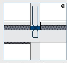
Variante A: Reduzierte Unterdeckendämmung an Wand
