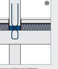
Variante B: Trennwand und Decke in Sichtbeton
