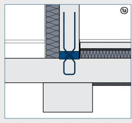
Variante A: Unterdeckendämmung an den Unterzug
