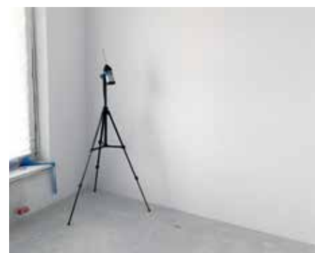
Pomieszczenie odbioru dźwięku do którego przylega klatka schodowa i wykonywany jest pomiar.
