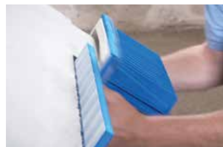
Rys. 8: Typ Z - wyjąć element ścienny i zapakować do transportu.
