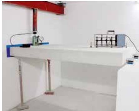
Stanowisko badawcze z Tronsole® typu Z i typu L do pomiarów dla spocznika.
