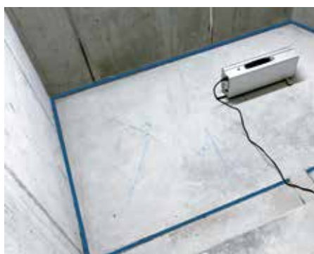
Wbudowane schody są pobudzane standardowym stukaczem młotkowym.
