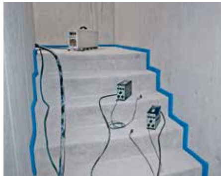
Wbudowane schody są pobudzane standardowym stukaczem młotkowym.
