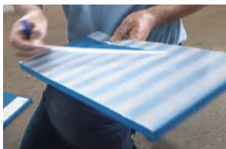
Rys. 7: Typ L - usunąć folię samoprzylepną i nakleić element
