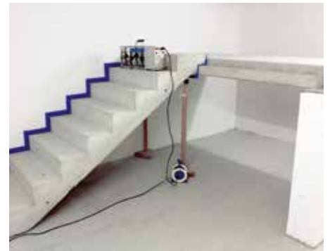
Stanowisko badawcze z Tronsole® typu F i typu L do pomiarów dla biegu schodów.
