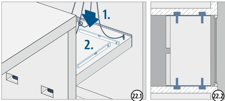
Nach dem Einbau des Wandelements Tronsole® Typ P Part W ist die Höhenlage des Podests durch druckfeste Ausgleichplatten (z. B. Stahl, Mindestgröße 180 x 120 mm) zu justieren.
