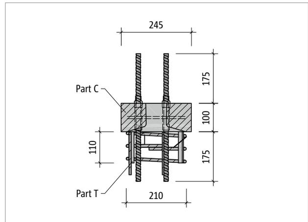
Abb. 92: Schöck Sconnex® Typ P-B250: Produktschnitt Part C und Part T
