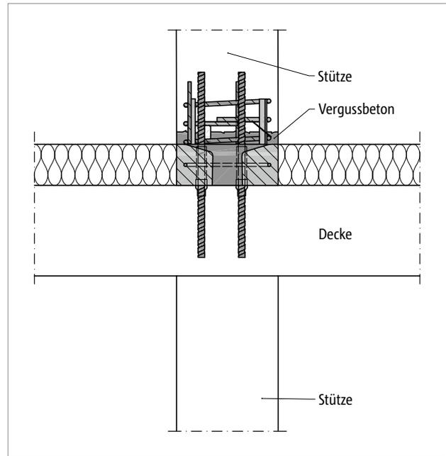
Abb. 65: Schöck Sconnex® Typ P-U: Anschluss einer Innenstütze an die darunterliegende Decke
