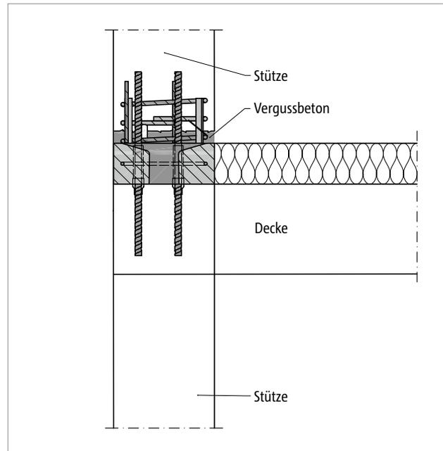
Abb. 67: Schöck Sconnex® Typ P-U: Anschluss einer Randstütze an die darunterliegende Decke
