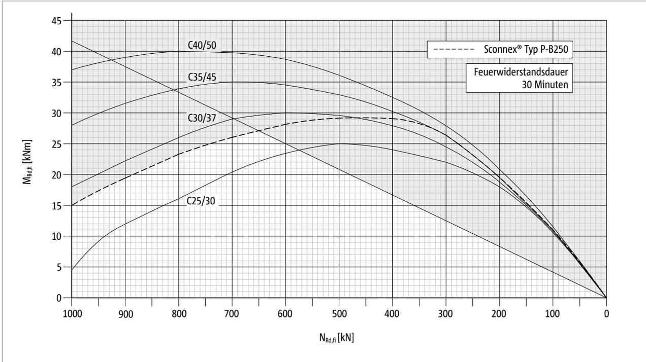
Abb. 79: Schöck Sconnex® Typ P-B250: Interaktionsdiagramm zur Bemessung für den Brandfall; Feuerwiderstandsklasse R 30
