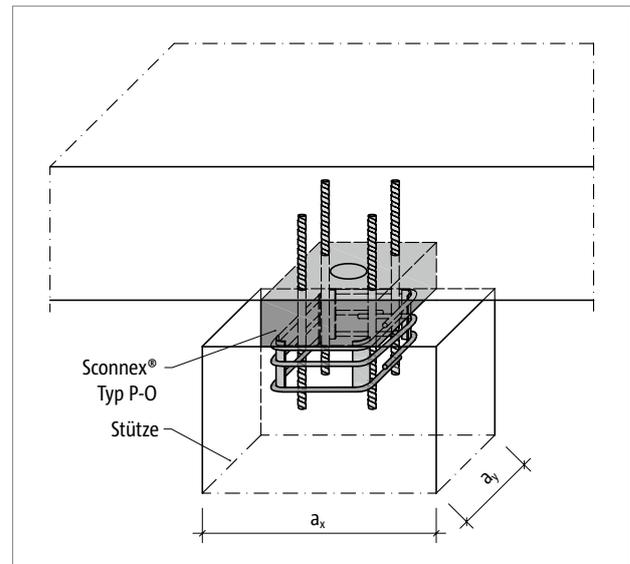
Abb. 71: Schöck Sconnex® Typ P-O: Anschluss bei rechteckiger Stütze; Einbau zentrisch – Stützenabmessungen  $a_x$  und  $a_y$ , siehe Seite 64 (gilt auch für Typ P-U)
