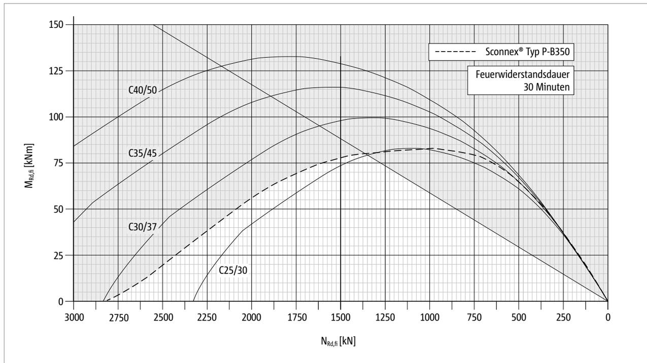
Abb. 85: Schöck Scconnex® Typ P-B350: Interaktionsdiagramm zur Bemessung für den Brandfall; Feuerwiderstandsklasse R 30
