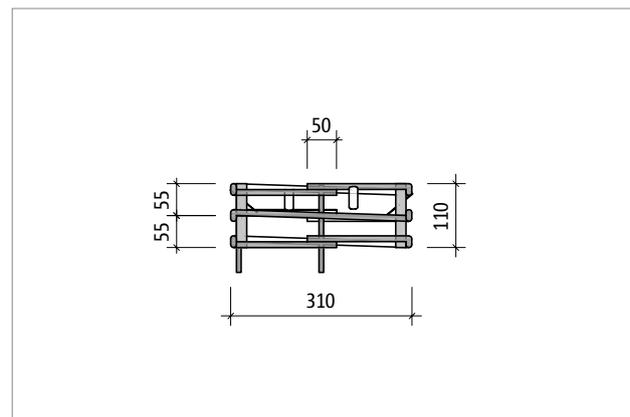
Abb. 106: Schöck Scconnex® Typ P-B350: Seitenansicht Part T; geschweißte Bügel und Biegeformsegmente aus Edelstahl
