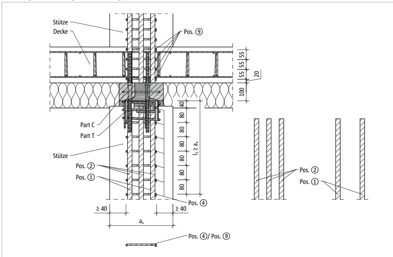
Abb. 121: Schöck Scconnex® Typ P-O: Bauseitige Bewehrung im Stützenlängsschnitt A-A (gilt auch für Typ P-U)
