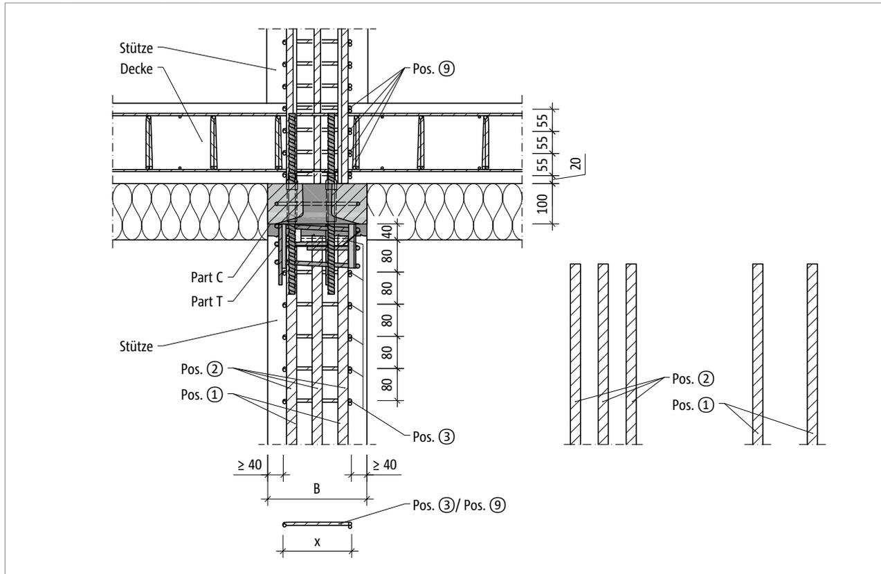
Abb. 119: Schöck Scconnex® Typ P-O: Bauseitige Bewehrung im Stützenlängsschnitt A-A (gilt auch für Typ P-U)
