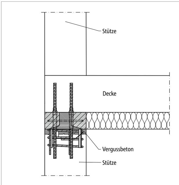
Abb. 66: Schöck Sconnex® Typ P-O: Anschluss einer Randstütze an die darüberliegende Decke
