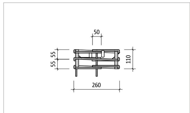
Abb. 100: Schöck Scconnex® Typ P-B300: Seitenansicht Part T; geschweißte Bügel und Biegeformsegmente aus Edelstahl
