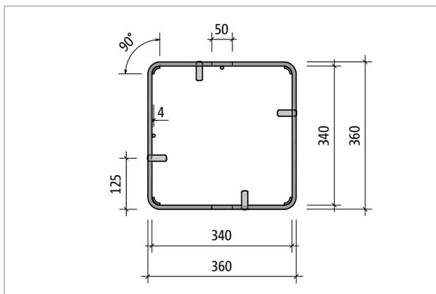
Abb. 111: Schöck Scconnex® Typ P-B400: Part T; geschweißte Bügel und Biegeformsegmente aus Edelstahl
