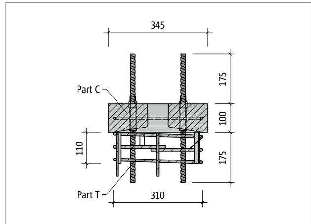
Abb. 104: Schöck Scconnex® Typ P-B350: Produktschnitt Part C und Part T
