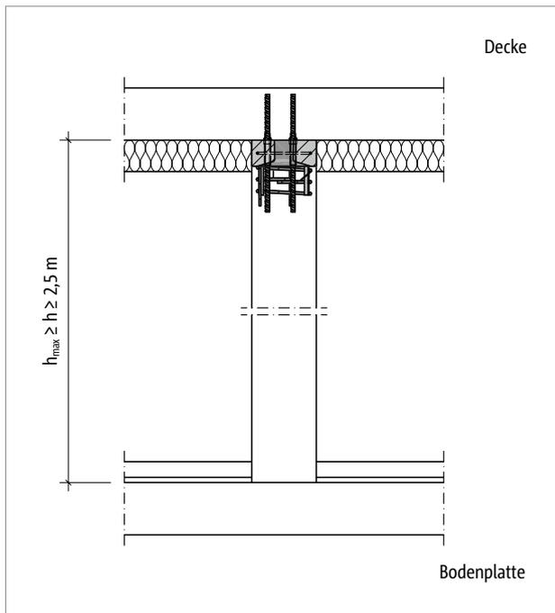
Abb. 73: Schöck Sconnex® Typ P-O: Mindest lichte Stützhöhe (Rohbaumaß) bei Verwendung des vereinfachten Bemessungsverfahrens (gilt auch für Typ P-U)
