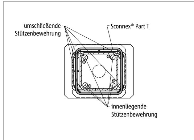
Abb. 116: Schöck Sconnex® Typ P: Bewehrungsführung im Bereich 2 – Stützenquerschnitt
