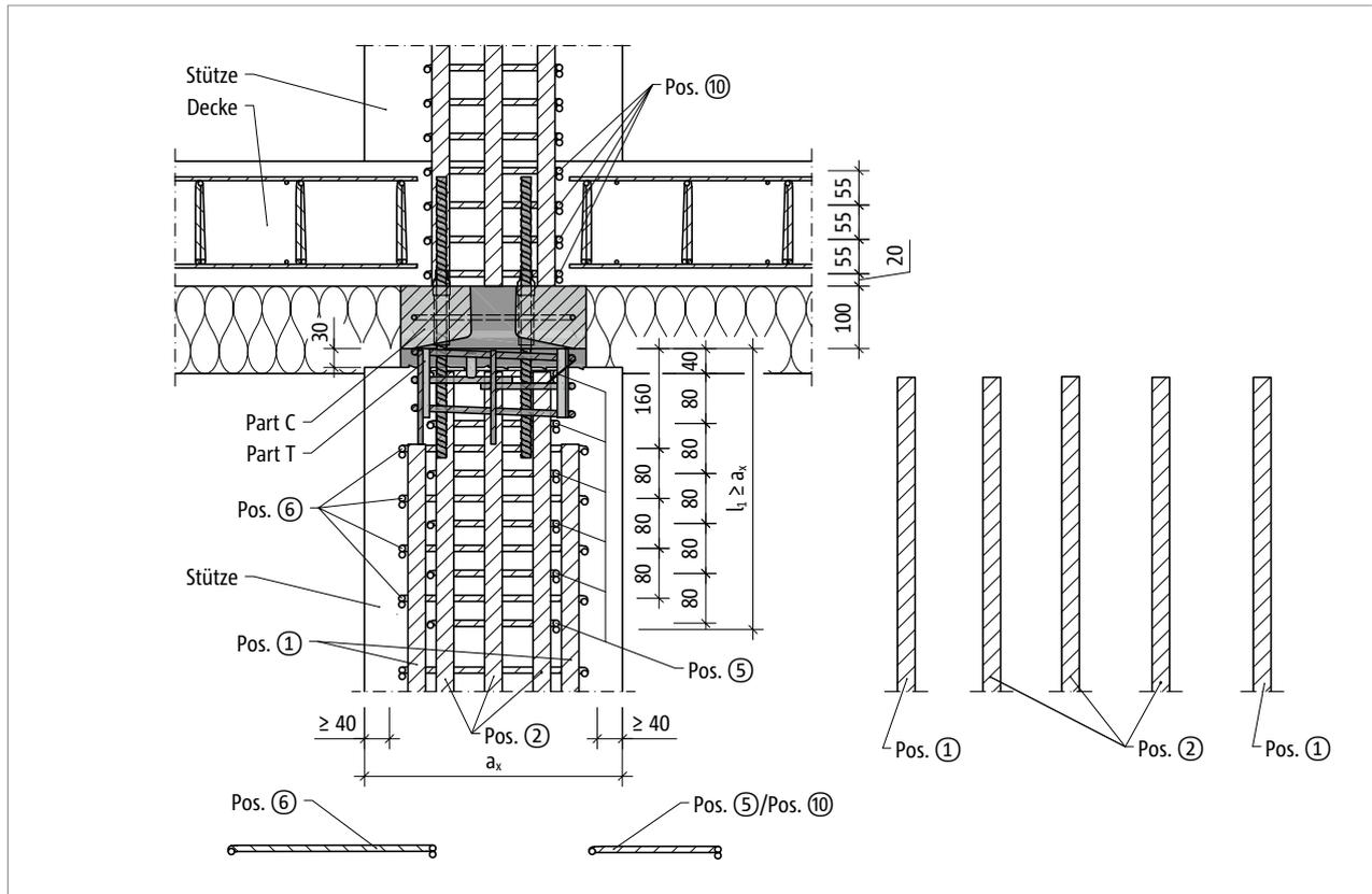
Abb. 123: Schöck Scconnex® Typ P-O: Bauseitige Bewehrung im Stützenlängsschnitt A-A (gilt auch für Typ P-U)
