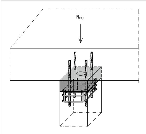
Abb. 131: Schöck Scconnex® Typ P-O: Vorzeichenregel für die Bemessung (gilt auch für Typ P-U)
