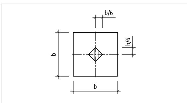
Abb. 76: Schöck Sconnex® Typ P: Begrenzung der Ausmitte auf die Kernfläche des Stützenquerschnitts mit  $e_x + e_y \leq b/6$ , klaffende Fuge nicht zulässig
