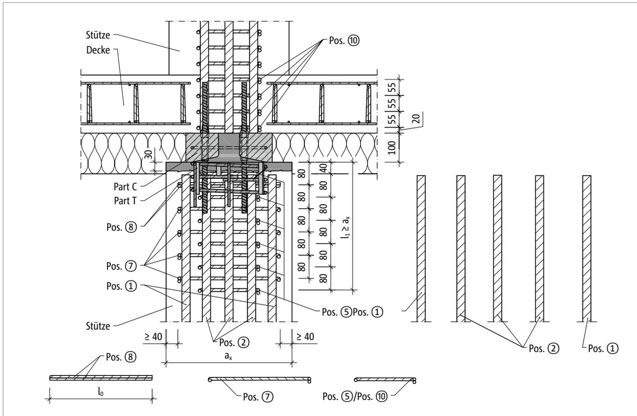
Abb. 125: Schöck Scconnex® Typ P-O: Bauseitige Bewehrung im Stützenlängsschnitt A-A (gilt auch für Typ P-U)
