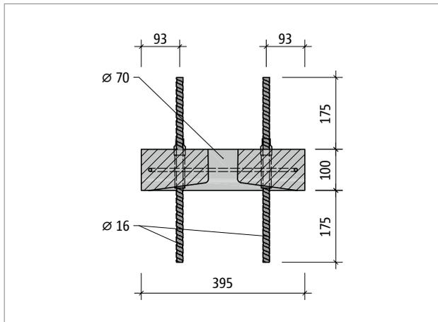
Abb. 109: Schöck Scconnex® Typ P-B400: Produktschnitt Part C
