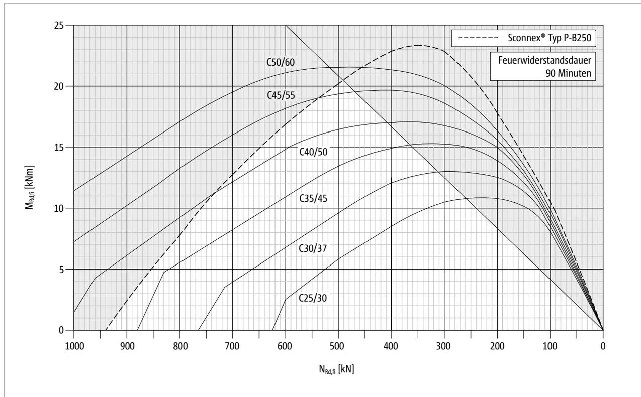
Abb. 77: Schöck Scconnex® Typ P-B250: Interaktionsdiagramm zur Bemessung für den Brandfall; Feuerwiderstandsklasse R 90
