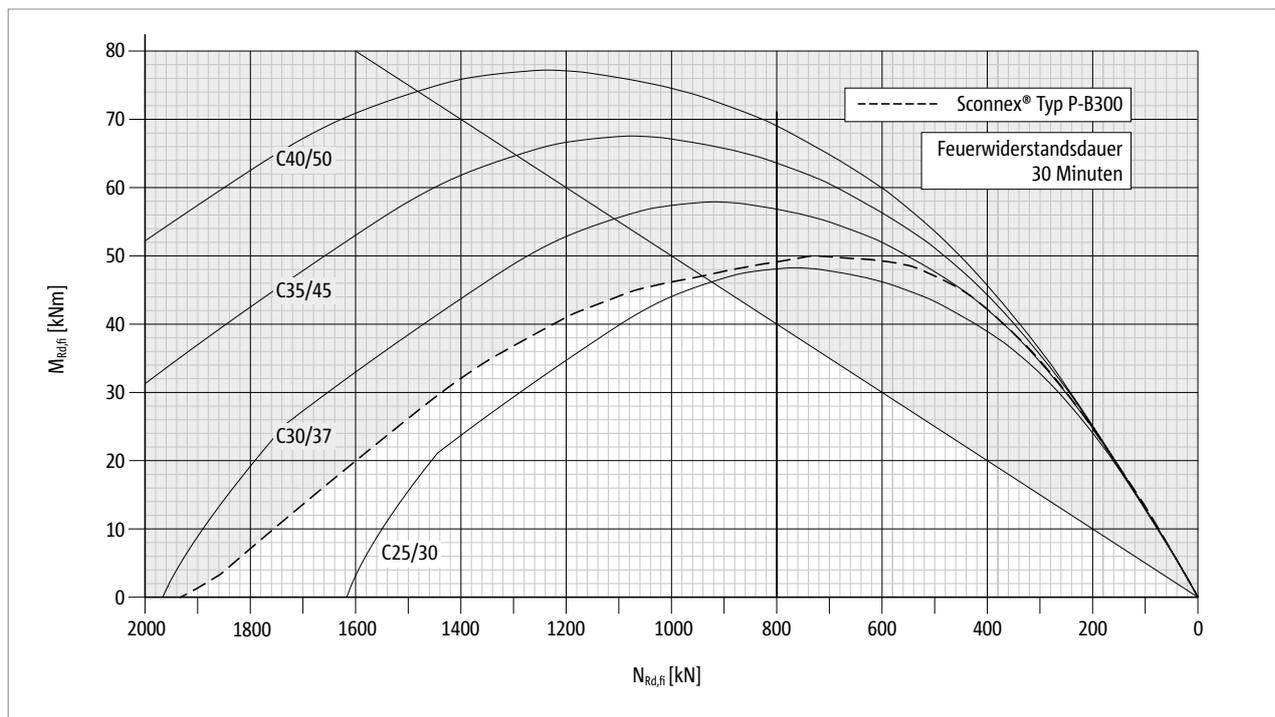
Abb. 82: Schöck Scconnex® Typ P-B300: Interaktionsdiagramm zur Bemessung für den Brandfall; Feuerwiderstandsklasse R 30
