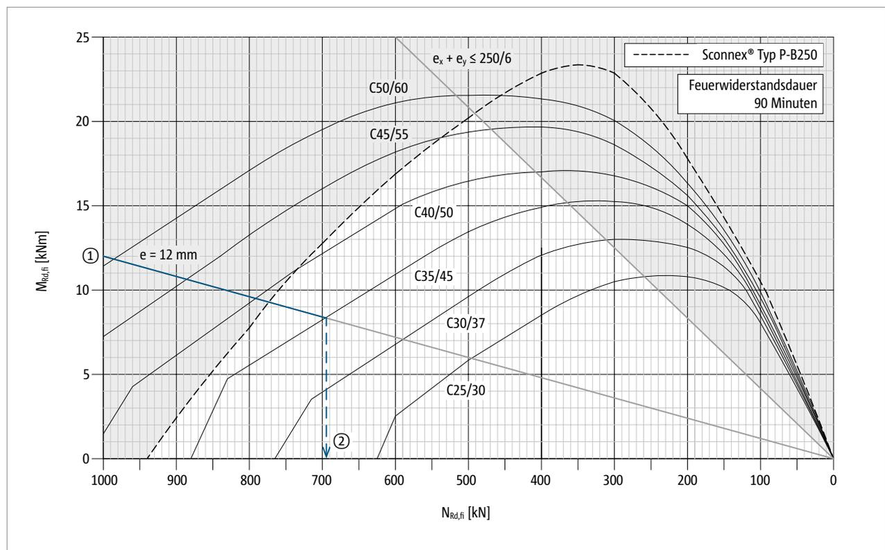
Abb. 132: Schöck Scconnex® Typ P-B250: Interaktionsdiagramm zur Bemessung für den Brandfall; Feuerwiderstandsklasse R 90
