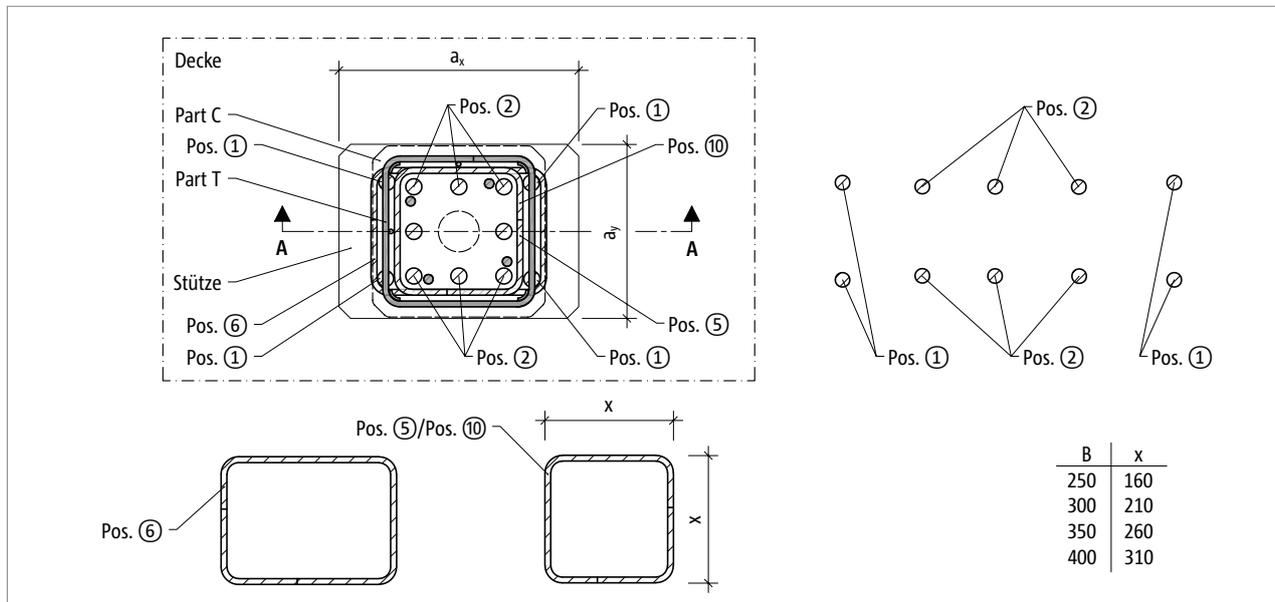
Abb. 124: Schöck Scconnex® Typ P: Bauseitige Bewehrung im Stützenquerschnitt
