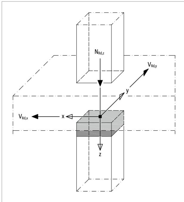
Abb. 75: Schöck Sconnex® Typ P-O: Vorzeichenregel für die Bemessung (gilt auch für Typ P-U)
