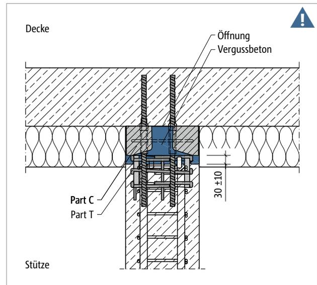
Abb. 128: Schöck Sconnex® Typ P-O: Einbausschnitt; Anschluss Stütze – Decke mit Formschluss zum Stützenbeton durch PAGEL®-Verguss (gilt auch für Typ P-U)
