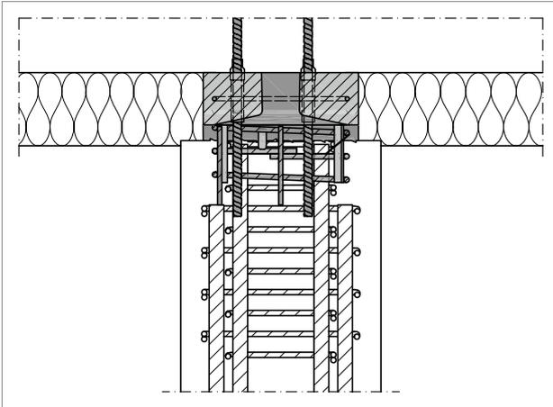
Abb. 115: Schöck Sconnex® Typ P-O: Bewehrungsführung im Bereich 2 – Stützenlängsschnitt (gilt auch für Typ P-U)
