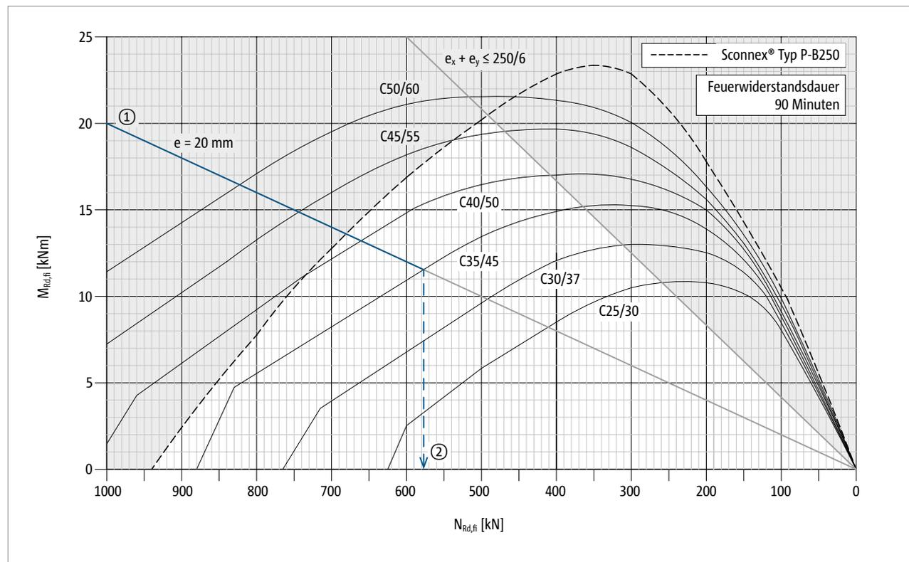
Abb. 130: Schöck Scconnex® Typ P-B250: Interaktionsdiagramm zur Bemessung für den Brandfall; Feuerwiderstandsklasse R 90
