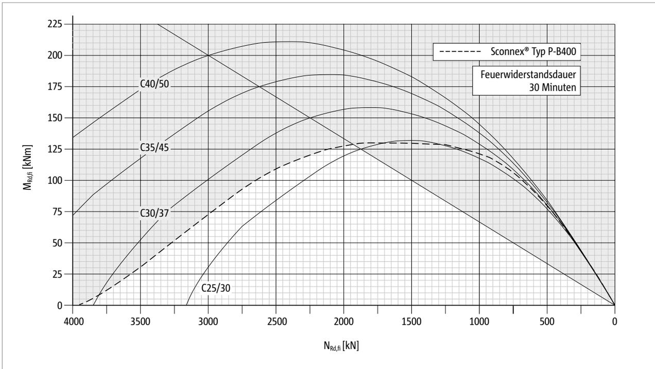
Abb. 88: Schöck Sconnex® Typ P-B400: Interaktionsdiagramm zur Bemessung für den Brandfall; Feuerwiderstandsklasse R 30
