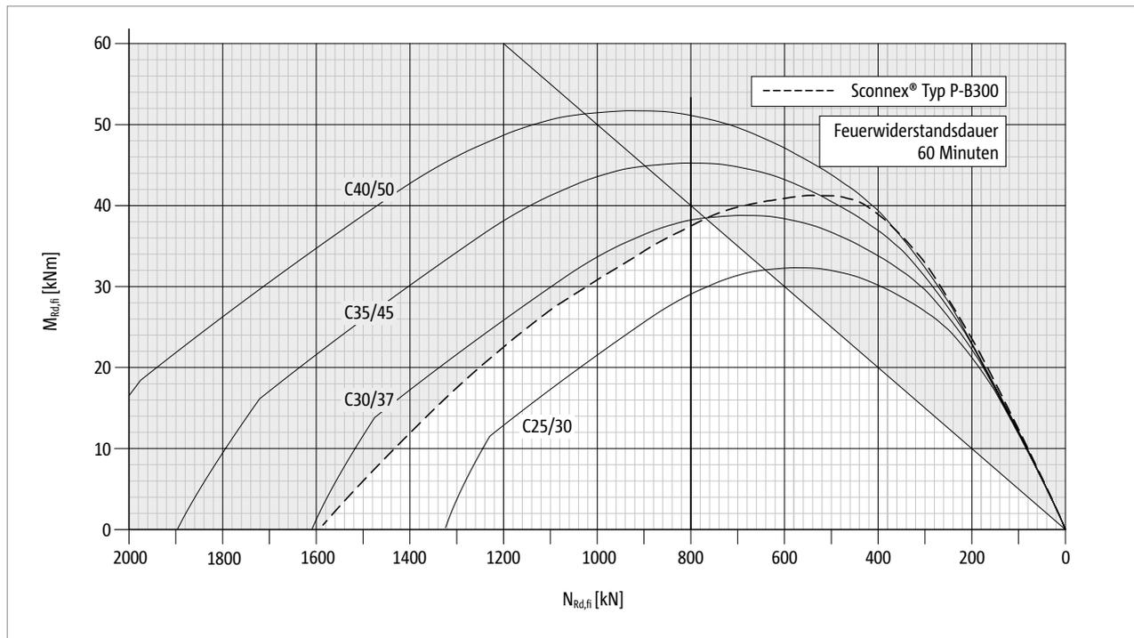
Abb. 81: Schöck Scconnex® Typ P-B300: Interaktionsdiagramm zur Bemessung für den Brandfall; Feuerwiderstandsklasse R 60
