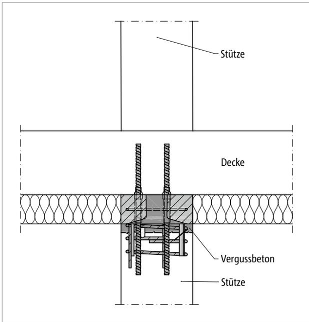
Abb. 64: Schöck Sconnex® Typ P-O: Anschluss einer Innenstütze an die darüberliegende Decke
