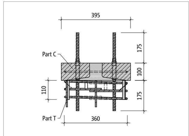
Abb. 110: Schöck Scconnex® Typ P-B400: Produktschnitt Part C und Part T
