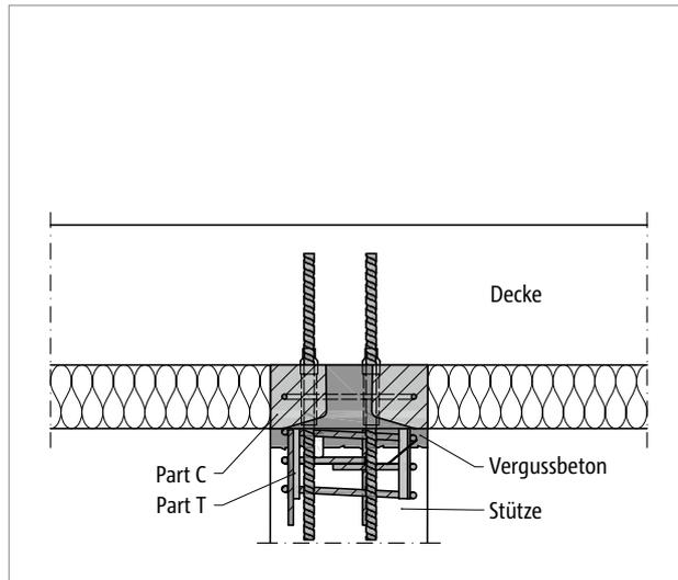
Abb. 68: Schöck Sconnex® Typ P-O: Einbauschritt; Anschluss bei quadratischer Stütze – Decke mit Part C und Part T
