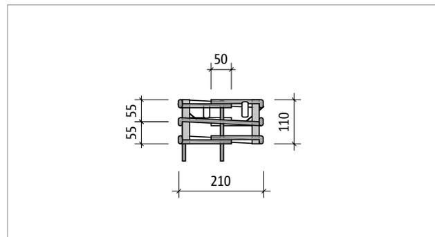
Abb. 94: Schöck Sconnex® Typ P-B250: Seitenansicht Part T; geschweißte Bügel und Biegeformsegmente aus Edelstahl
