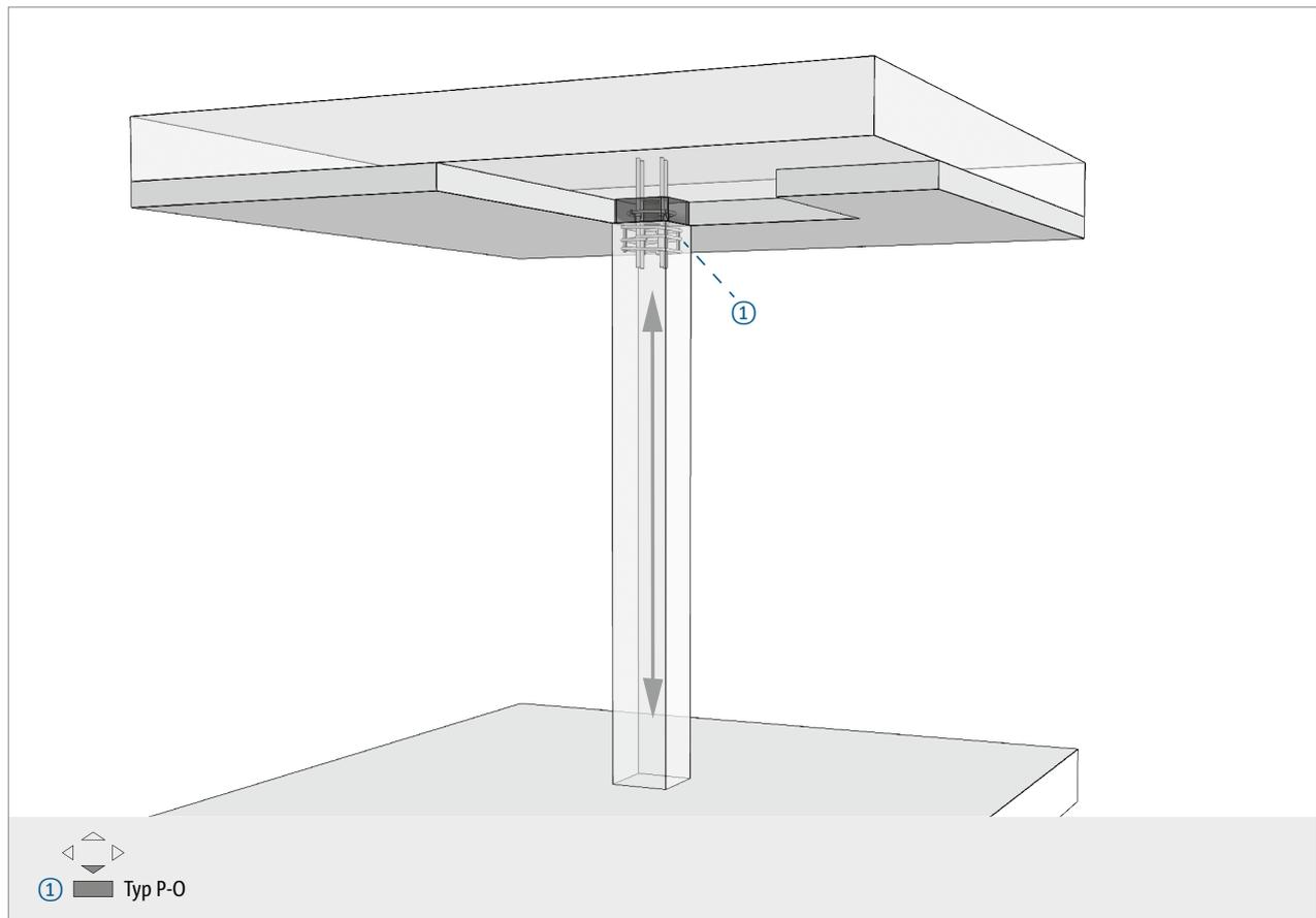
Abb. 72: Stützenanschluss bei Unterdeckendämmung (gilt auch für Typ P-U)
