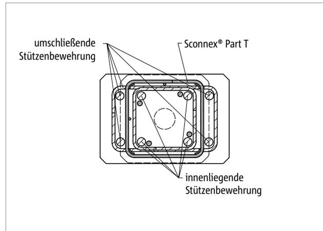
Abb. 118: Schöck Sconnex® Typ P: Bewehrungsführung im Bereich 3 – Stützenquerschnitt
