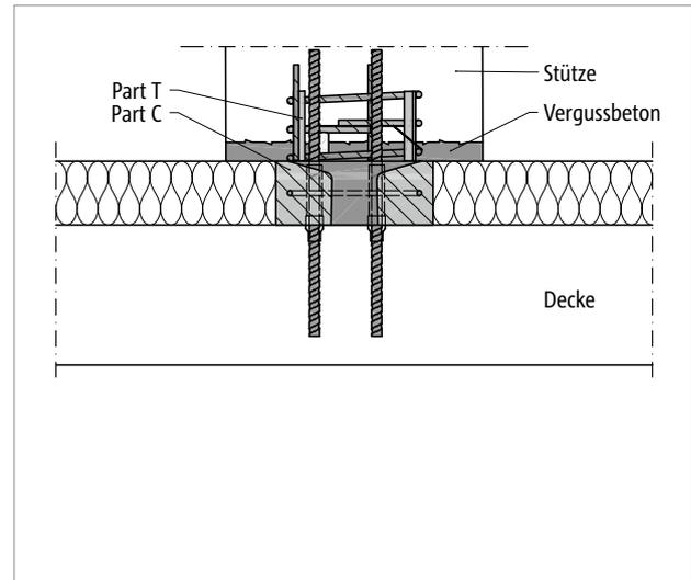
Abb. 69: Schöck Sconnex® Typ P-U: Einbauschritt; Anschluss bei rechteckiger Stütze – Decke mit Part C und Part T
