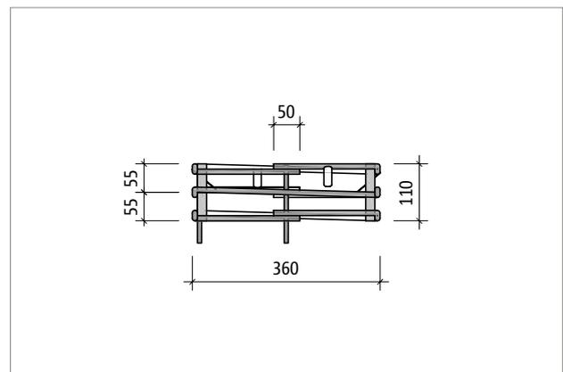
Abb. 112: Schöck Scconnex® Typ P-B400: Seitenansicht Part T; geschweißte Bügel und Biegeformsegmente aus Edelstahl
