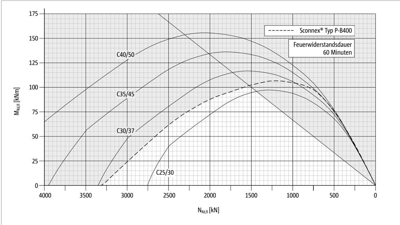
Abb. 87: Schöck Sconnex® Typ P-B400: Interaktionsdiagramm zur Bemessung für den Brandfall; Feuerwiderstandsklasse R 60
