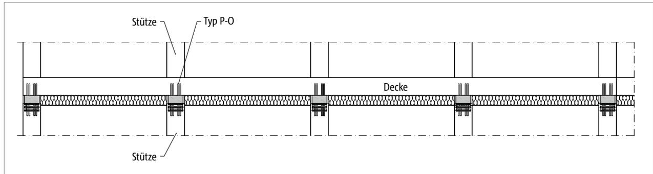
Abb. 61: Schöck Scconnex® Typ P-O: Stützenanschluss an die darüberliegende Decke
