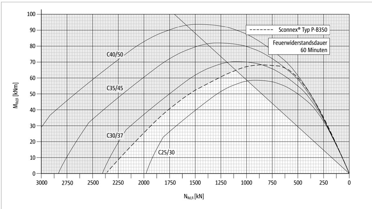
Abb. 84: Schöck Scconnex® Typ P-B350: Interaktionsdiagramm zur Bemessung für den Brandfall; Feuerwiderstandsklasse R 60
