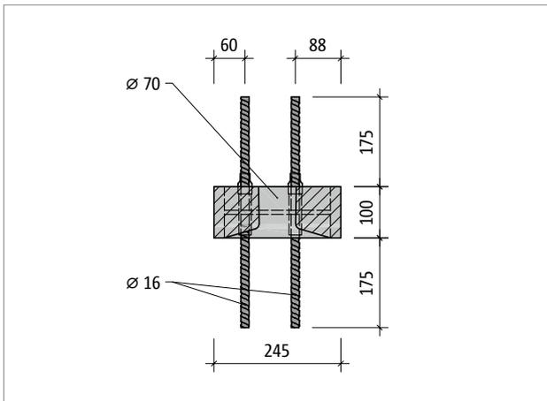
Abb. 91: Schöck Sconnex® Typ P-B250: Produktschnitt Part C
