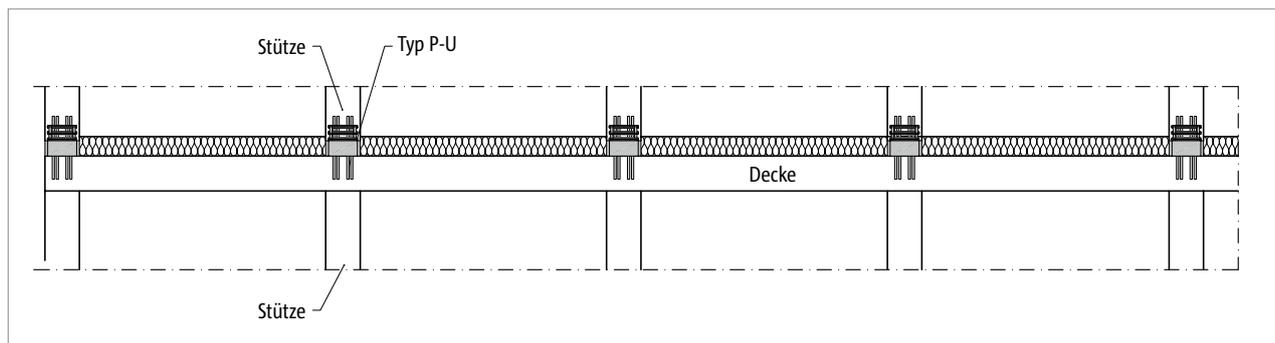
Abb. 62: Schöck Scconnex® Typ P-U: Stützenanschluss an die darunterliegende Decke
