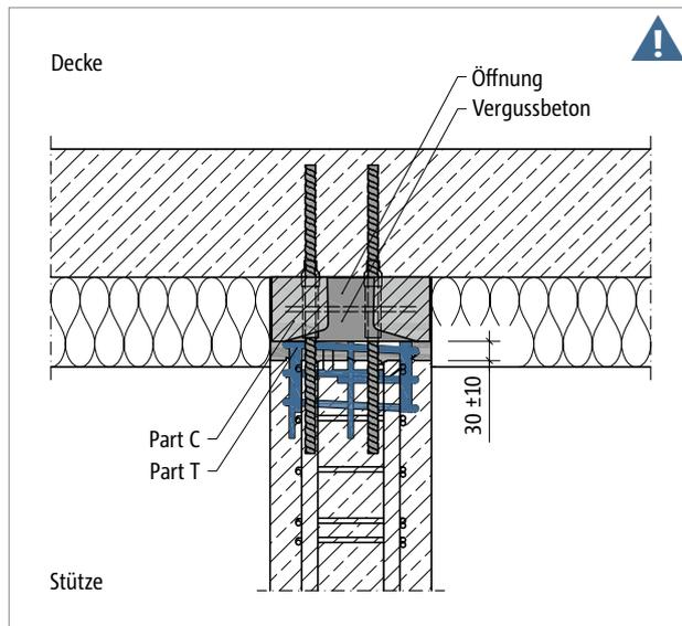
Abb. 127: Schöck Sconnex® Typ P-O: Einbausschnitt; Anschluss Stütze – Decke mit eingebautem Part T für die Tragsicherheit in Kombination mit Part C (gilt auch für Typ P-U)
