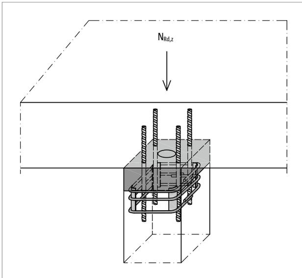
Abb. 129: Schöck Sconnex® Typ P-O: Vorzeichenregel für die Bemessung (gilt auch für Typ P-U)
