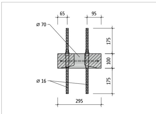
Abb. 97: Schöck Scconnex® Typ P-B300: Produktschnitt Part C
