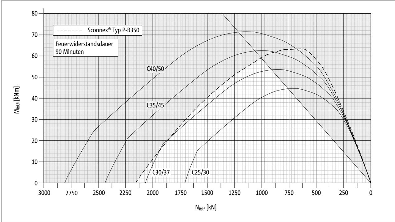
Abb. 83: Schöck Scconnex® Typ P-B350: Interaktionsdiagramm zur Bemessung für den Brandfall; Feuerwiderstandsklasse R 90
