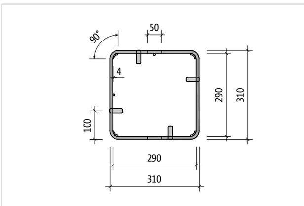
Abb. 105: Schöck Scconnex® Typ P-B350: Part T; geschweißte Bügel und Biegeformsegmente aus Edelstahl
