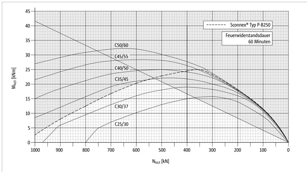
Abb. 78: Schöck Scconnex® Typ P-B250: Interaktionsdiagramm zur Bemessung für den Brandfall; Feuerwiderstandsklasse R 60
