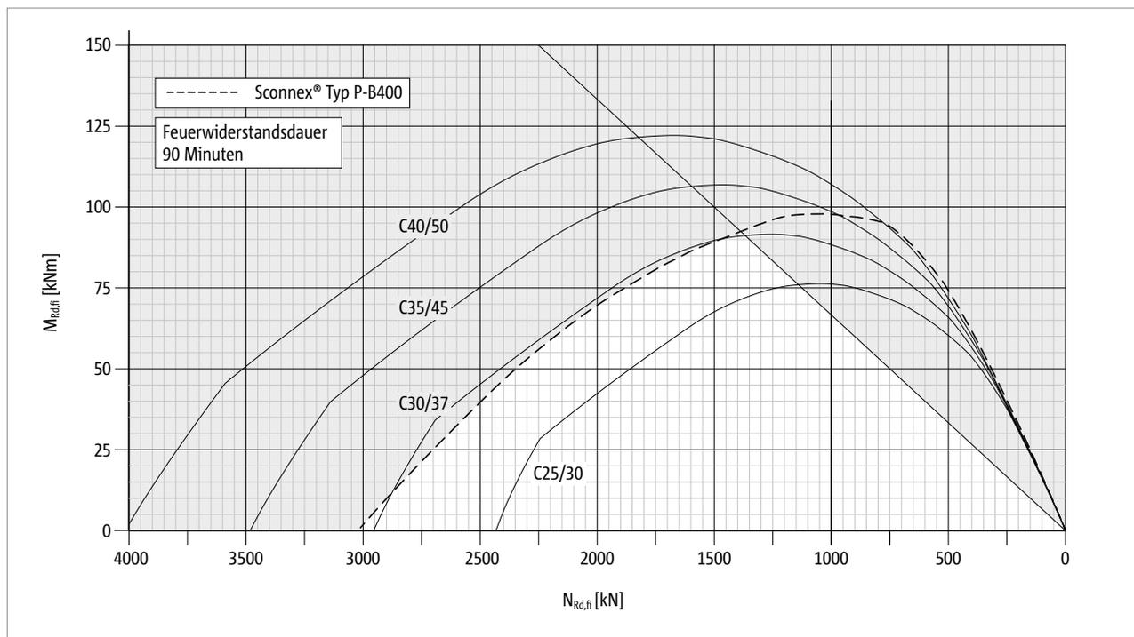
Abb. 86: Schöck Scconnex® Typ P-B400: Interaktionsdiagramm zur Bemessung für den Brandfall; Feuerwiderstandsklasse R 90
