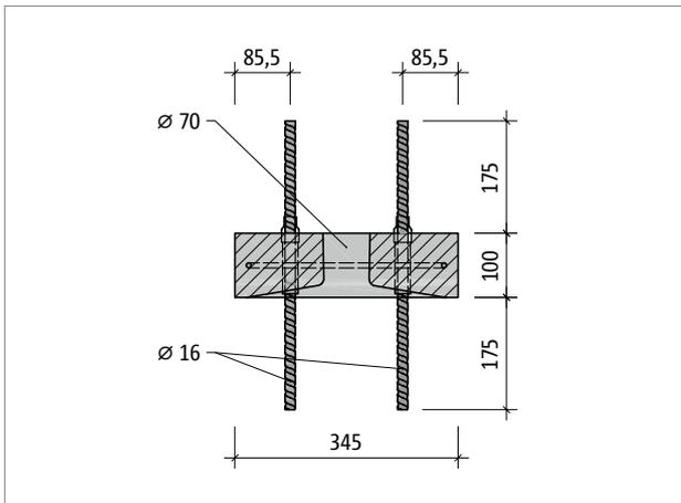
Abb. 103: Schöck Scconnex® Typ P-B350: Produktschnitt Part C
