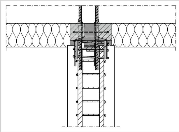
Abb. 113: Schöck Sconnex® Typ P-O: Bewehrungsführung im Bereich 1 – Stützenlängsschnitt (gilt auch für Typ P-U)
