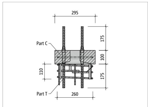
Abb. 98: Schöck Scconnex® Typ P-B300: Produktschnitt Part C und Part T
