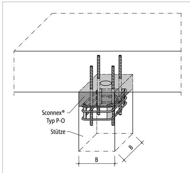
Abb. 70: Schöck Sconnex® Typ P-O: Anschluss bei quadratischer Stütze (gilt auch für Typ P-U)
