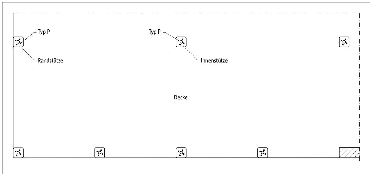
Abb. 63: Schöck Scconnex® Typ P: Elementanordnung im Grundriss
