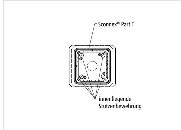
Abb. 114: Schöck Sconnex® Typ P: Bewehrungsführung im Bereich 1 – Stützenquerschnitt
