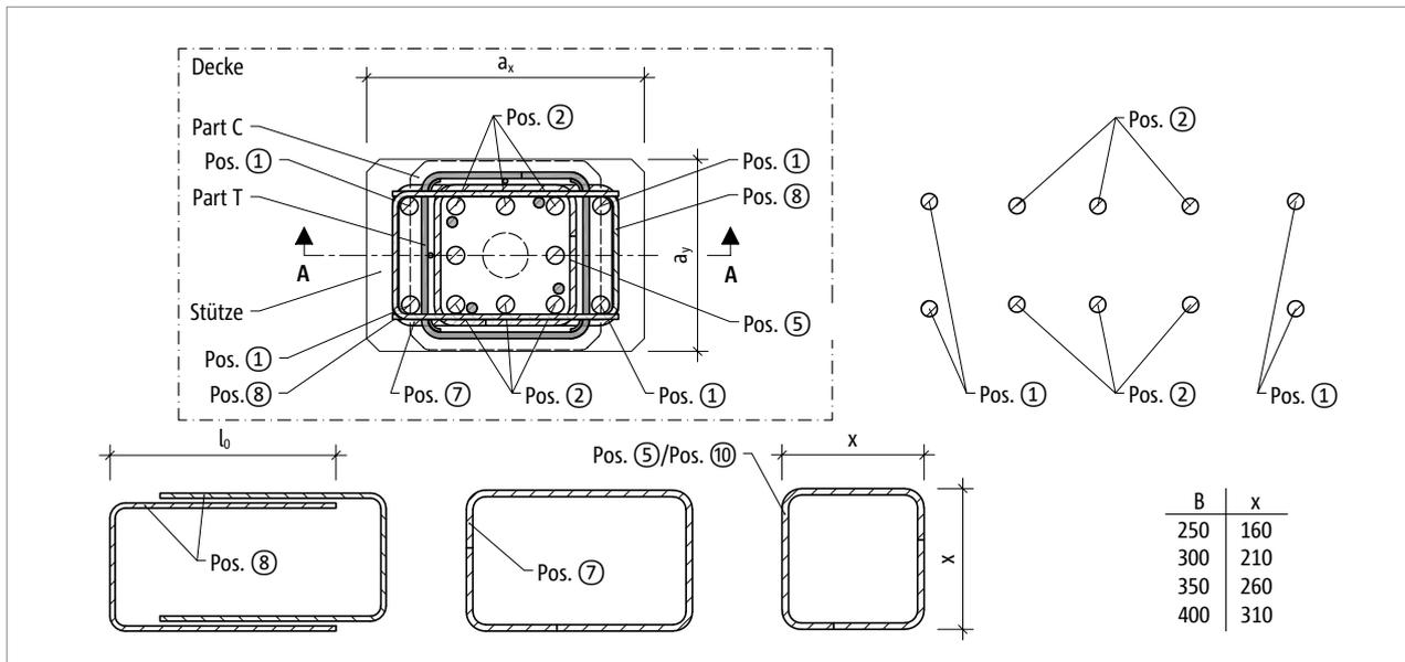
Abb. 126: Schöck Scconnex® Typ P: Bauseitige Bewehrung im Stützenquerschnitt
