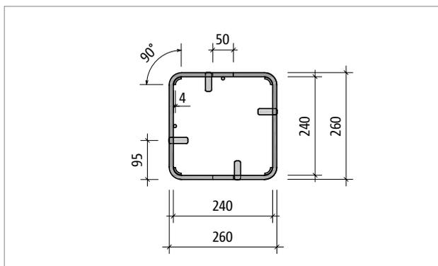
Abb. 99: Schöck Scconnex® Typ P-B300: Part T; geschweißte Bügel und Biegeformsegmente aus Edelstahl
