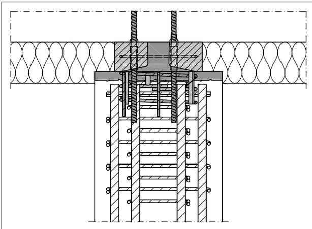
Abb. 117: Schöck Sconnex® Typ P-O: Bewehrungsführung im Bereich 3 – Stützenlängsschnitt (gilt auch für Typ P-U)
