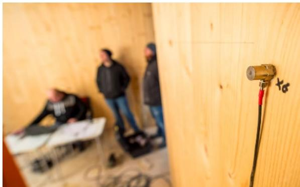
Da die erste Messung zu einem frühen Stadium im Rohbau, als die Trockenbau-Wände noch nicht erstellt waren, durchgeführt wurde, erfolgte sie über Körperschallauflnehmer anstatt über eine direkte Luftschallmessung mittels Mikrofon.
