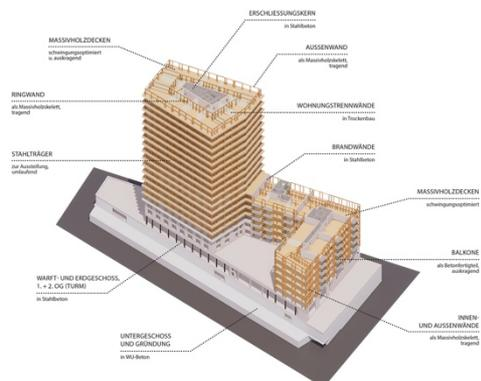
Die isometrische Darstellung des Roots zeigt die verschiedenen Teile und den Gebäudeaufbau des Hochhauses.
