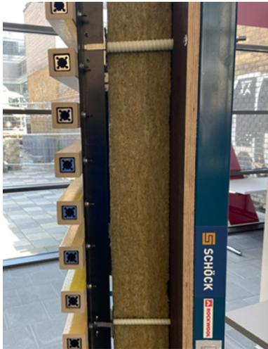
*Der Fassadenaufbau am ZDD Düsseldorf im Modell: Durch den Einsatz der Fassadenbefestigung Schöck Isolink Typ F konnte die Wärmedämmdicke am ZDD Düsseldorf entscheidend reduziert werden.*
