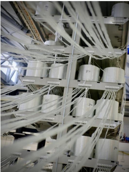
*Im Pultrusionsverfahren zur Herstellung von Combar werden Glasfasern dicht gebündelt und mit flüssigem Kunstharz umschlossen. Anschließend werden Rippen in die Stäbe geschnitten.*
