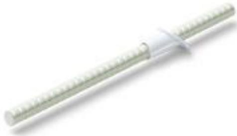
*Der Schöck Isolink Typ C-SD aus Glasfaserverbundwerkstoff mit geraden Enden wird diagonal in kerngedämmte Sandwichwände mit freihängender Vorsatzschale eingesetzt. Foto: Schöck Bauteile GmbH*
