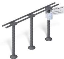
*Die Schöck Bole Typ O ist eine Durchstanzbewehrung und wird nach dem Verlegen der unteren und oberen Deckenbewehrung eingebaut. Foto: Schöck Bauteile GmbH*
