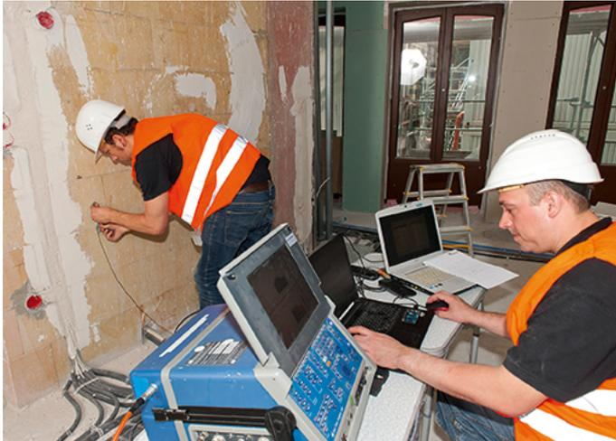
*Um den Norm-Trittschallpegel im vorgefundenen Rohbauzustand messen zu können, wurden von der Schalltechnischen Entwicklungs- und Prüfinstitut GmbH (STEP) Körperschallmessungen auf den Treppenraumwänden durchgeführt. Durch die effektive Entkopplung mit dem Produktprogramm Schöck Tronsole konnten hervorragende Werte erzielt werden, die den Bewohnern einen komfortablen Schallschutz bieten. Foto: Schöck Bauteile GmbH, Abdruck honorarfrei*
