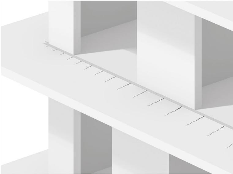
*Bei einer durchlaufenden Stahlbetonplatte können infolge von thermischen Belastungen Risse in der Stahlbetonplatte entstehen.
