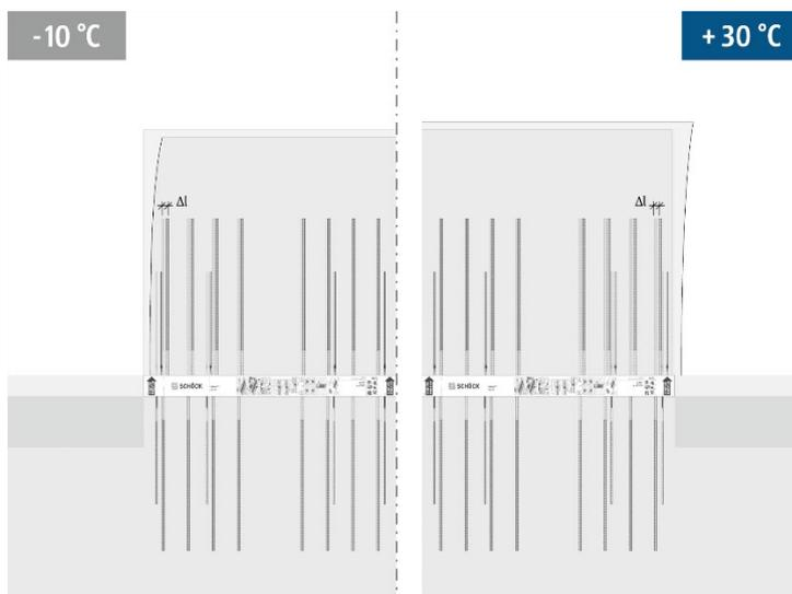
Verformung von Stahlbetonbalkonen bei thermischer Belastung.
